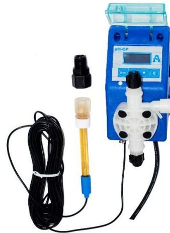
Tanto el instrumento de conductividad CD-C, el de pH y temperatura modelo PH-C, como así también el de potencial RedOx modelo RX-C cuentan con 2 relays ON/OFF, 1 salida de 4-20 mA, y salida opcional tipo ModBus para su control a distancia, o almacenamiento de datos descargables en planillas de cálculo.
